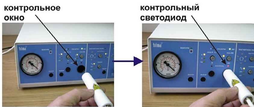
Рис.21. Контроль мощности излучения «инфракрасного» лазера.
