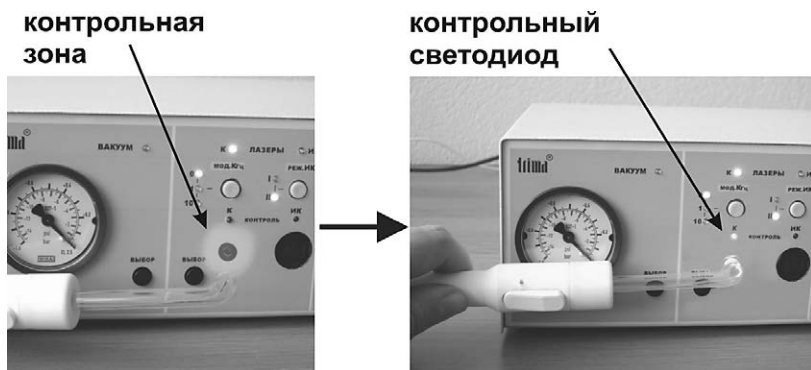
Рис. 20. Контроль мощности лазерного излучения «красного» лазера.
