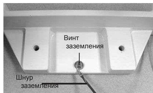
Фото - 3 Заземление подбородника
